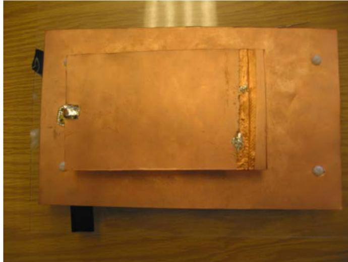
Figure 3.6. Patch antenna.
