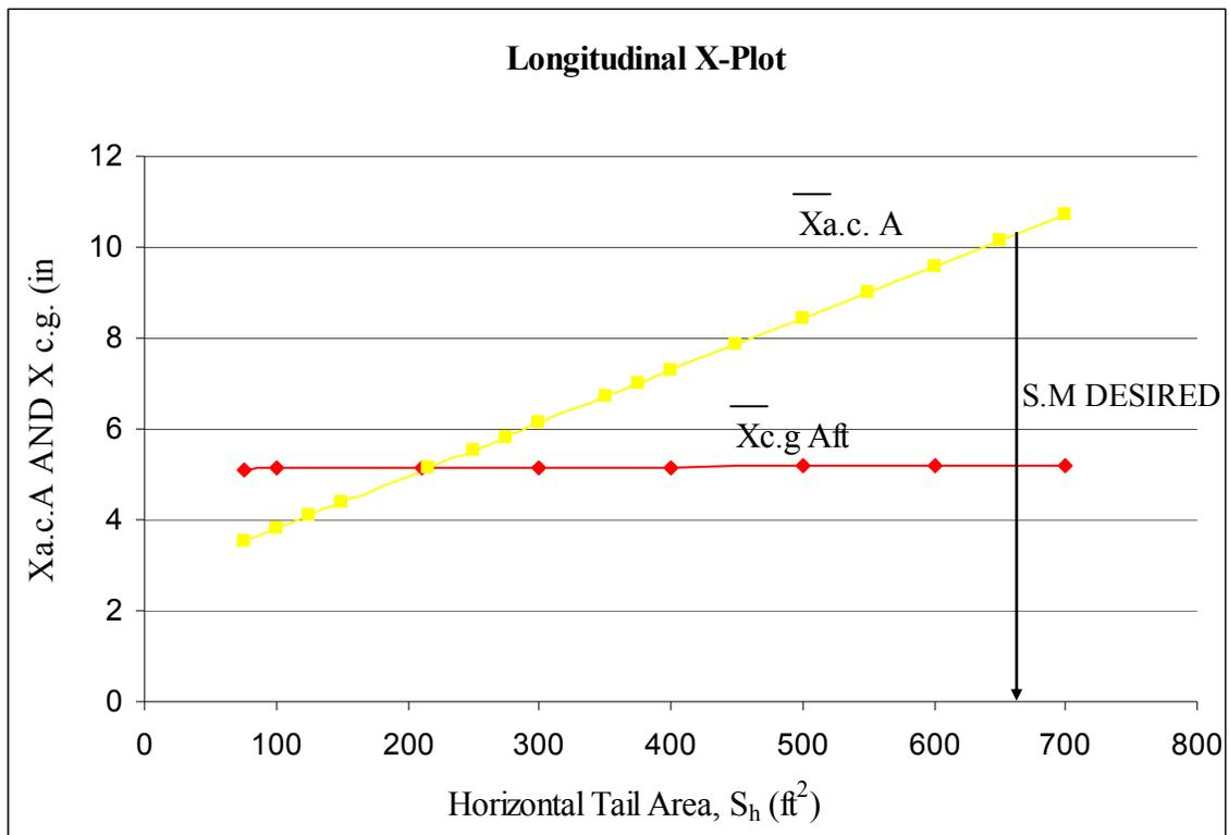
Figure 37. Longitudinal X-plot
