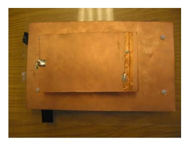
Figure 3.6. Patch antenna.
