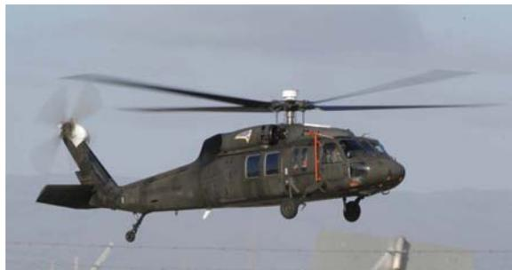
Fig. 28 AFDD RASCAL JUH-60A in-flight simulator.
